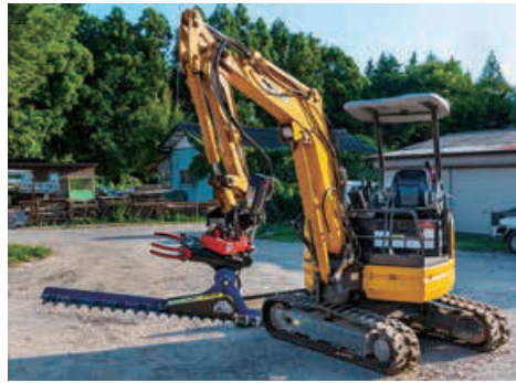
チルトローテーター「ROTOTILT」と草刈りアタッチメント「SLANETRAC」を組み合わせることで、今までとは比較にならないほどの作業効率を実現する。
